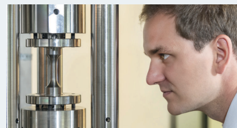
Ein BAM-Mitarbeiter inspiziert den Testaufbau eines Wasserstoffwerkstoffprüfers. Foto: BAM
