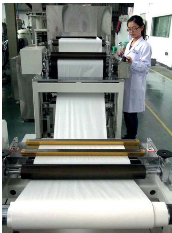
Abb. 2. Nanofibrilläre Cellulose-Kompositmembran für Lithiumbatteriediaphragmen; Pilotanlage des CAS Qingdao Institute for Bioenergy and Bioprocess Technology. Foto: Qingdao
